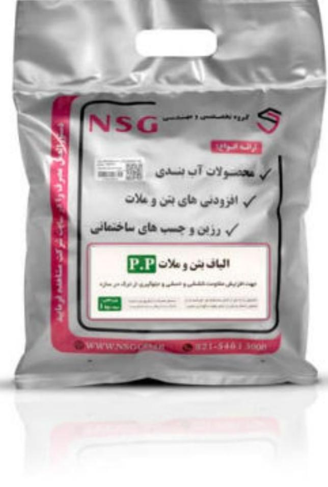
الیاف شبیه ای رنگ از جنس تراشه های پلی پروپیلن می باشد که جهت بالا بردن مقاومت خمشی و کششی سازه و ممانعت از ایجاد ترک های سطحی و عمقی در بتن، ملات های سیمانی و گچی مورد استفاده قرار می گیرد. منقبض شدن بتن و ملات، پس از خشک شدن و رسیدن به گیرش نهایی منجر به تغییر ابعاد حجمی آنها شده و باعث بوجود آمدن ترک های سطحی و عمقی فراوانی می گردد. با استفاده از مقدار کمی الیاف P.P در هنگام بتن ریزی و سیمانکاری، ترک ها به طور چشمگیری کاهش می یابند.
